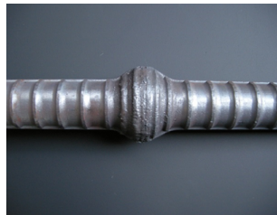
アセチレン圧接
